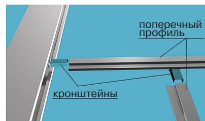
3. Вставить алюминиевые кронштейны в поперечный профиль и соединить его с основным профилем.
