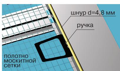
4. Отрезать полотно москитной сетки в размер, равный габаритам изделия. Вставить пластиковую ручку в основной профиль в том месте, где это необходимо, и закатать полотно сетки в паз основного профиля при помощи шнура и закаточного ролика. При этом используется ребристый шнур диаметром 4,8 мм.
