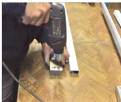
4. Затем сверлом диаметром 4,1 мм просверливается отверстие ближе к внутренней стороне направляющей.
