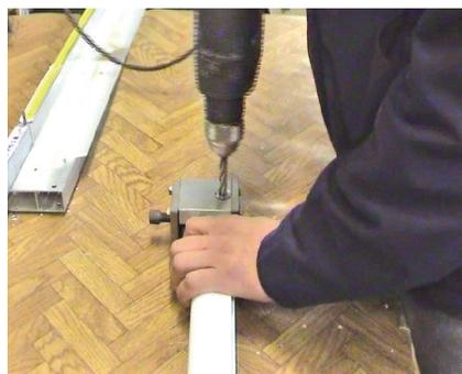
2. После этого сверлом диаметром 8,7 мм просверливается отверстие для доступа к червяку. Впоследствии данное отверстие закрывается заглушкой.
