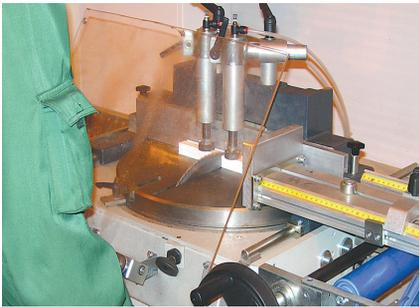
1. Отрезать основной профиль в размер, равный ширине (длине) изделия, минус удвоенная ширина (В) видимой части уголка.
