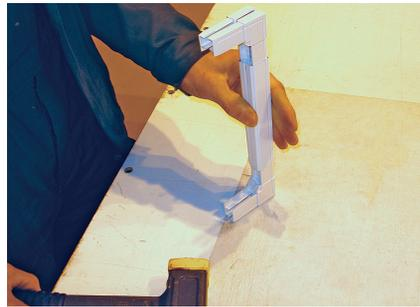
2. Скрепить основной профиль с помощью уголков, используя инерционный молоток.
