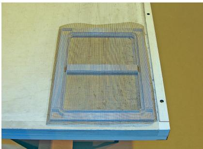
4. Отрезать полотно москитной сетки по размеру изделия с припуском примерно 30–40 мм.
