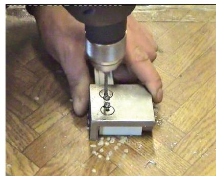
8. С помощью сверла диаметром 4,1 мм в фиксирующей планке просверливается отверстие. Аналогичная операция продельвается с другой стороны фиксирующей планки.
