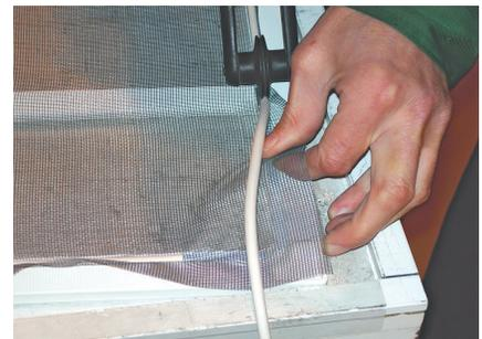
6. Также рекомендуется следить, чтобы полотно сетки не прогибалось и не сборилось. Для этого в процессе закатывания следует слегка равномерно натягивать полотно сетки.
